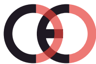
Marcatura CE contraffatta (troppo vicino)
