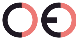
Marcatura CE contraffatta (troppo distante)
